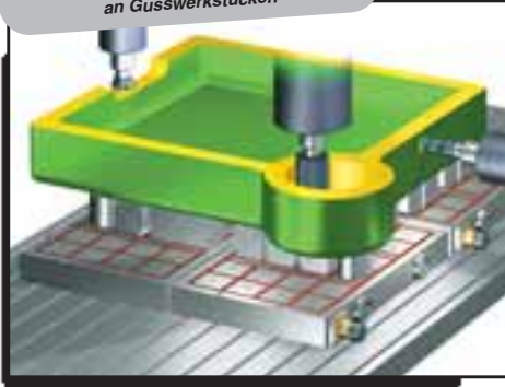
Planfräsen und Konturfräsen an Gusswerkstücken
