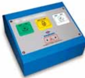
Mehrkanalgerät zum Ansteuern von mehreren Magnetplatten
