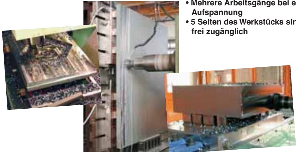
• Wenden, Schruppen, Entspannen (DEMAG/MAG) und Schlichten der 2. Fläche
